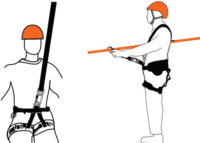
**Not / Note :****(TR)** Ürün bir lanyard olarak kullanıldığında karabina + şok emici + lanyard + karabina toplam boyu maksimum 2 metreyi geçmemelidir.**(EN)** When using as a lanyard, total length of carabiner + shock absorber + lanyard + carabiner should not exceed 2 meters.**F-1.2 Lanyard / Lanyard**
