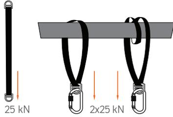
**Not / Note :****(TR)** Eğer profil kare veya yuvarlak ise profilin çapı minimum 55 mm olmalıdır.**(EN)** If profile is in round or square shape then the diameter of the profile must be minimum 55 mm.**F-1.1 Ankraj Sapanı / Anchorage Strap**
